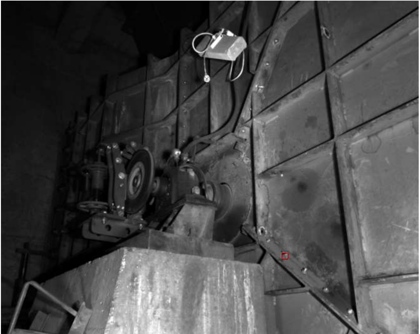
Rys8. Konstrukcja oprawy wentylatora strony NDE.
